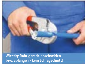
Hinweis: Die vordere Spitze des Rohrcutters ermöglicht das Schneiden von Leerrohren.
