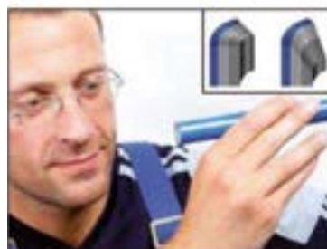
Wichtig: Systemfittings bis zum Anschlag aufschieben - Kontrolle im Sichtfenster.
